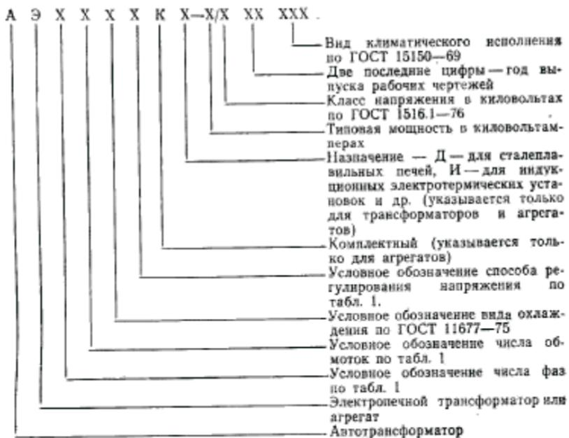
1.4. Структура условного обозначения сухих трансформаторов должна указываться в стандартах или технических условиях на конкретные типы трансформаторов.
